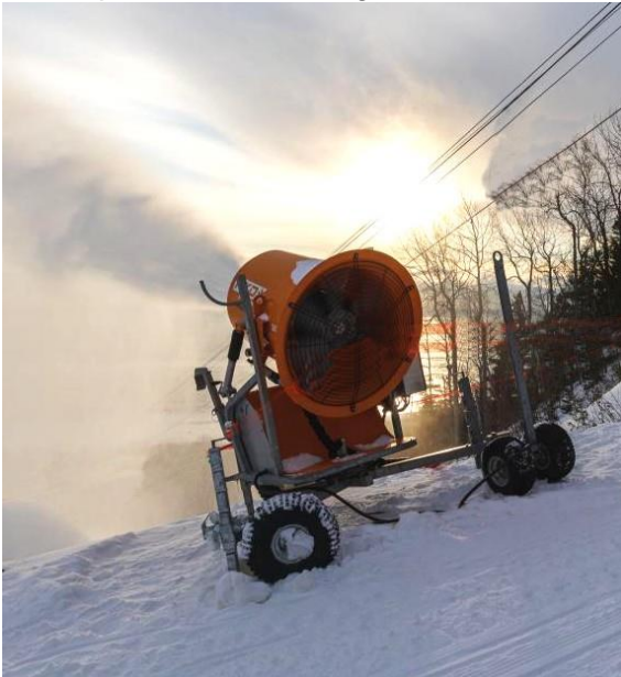
A droite, un canon à ventilateur avec un compresseur intégré d'Atlas Copco.
