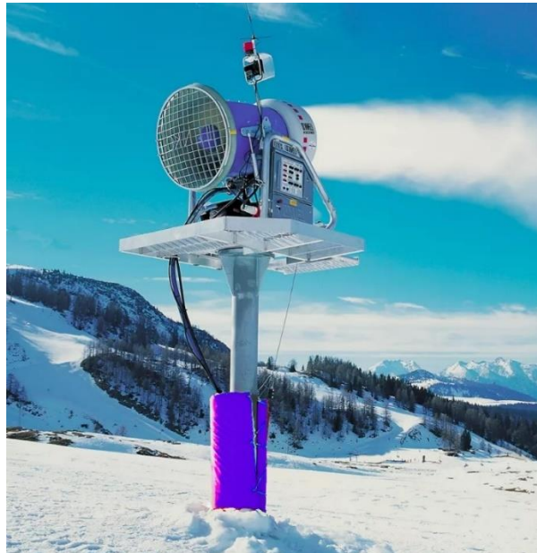
A droite, un canon à ventilateur avec un compresseur intégré d'Atlas Copco.
